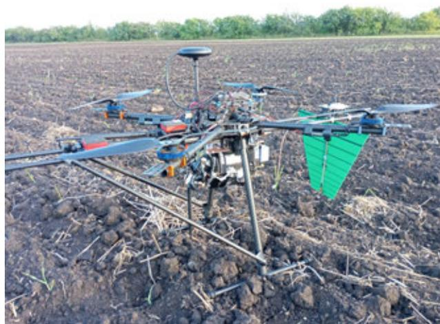
Рис. 3. Внешний вид БПЛА-рефлектометра.
