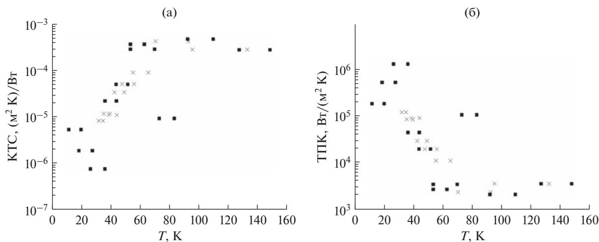
**Рис. 6.** Зависимость ТПК (а) и КТС (б) контактной пары Cu—Cu в диапазоне температур 20...160 К при контактном давлении 200 кПа без внешнего магнитного поля — квадратный символ, зависимость ТПК КТС контактной пары Cu—Cu в диапазоне температур 20...160 К при контактном давлении 200 кПа в магнитном поле 5 Тл — перекрестный символ.
