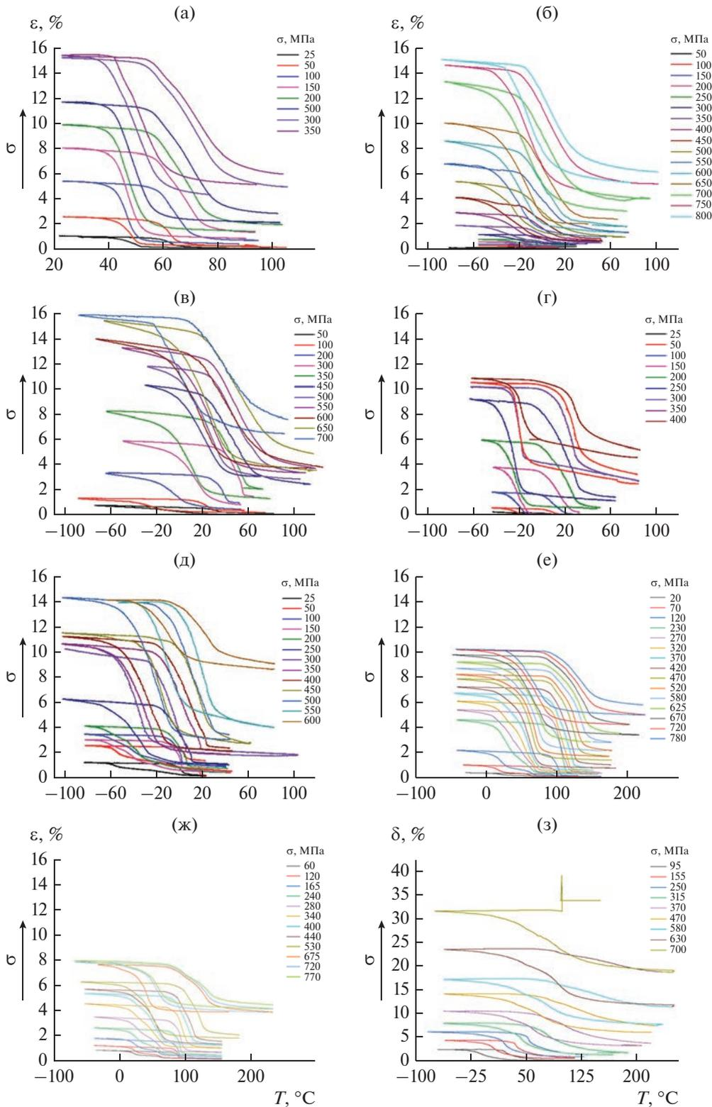
**Рис. 1.** Зависимость деформации от температуры и нагрузки для исследуемых образцов (см. табл. 1): 1-1 ГК05 (а), 1-2ТК (б), 1-3 РКУП + ТК (в), 2-1 ГК20 (г), 2-2 РКУП (д), 3-1 ТК450 (е), 3-2 ТК500 (ж), 4-1 П (з).
